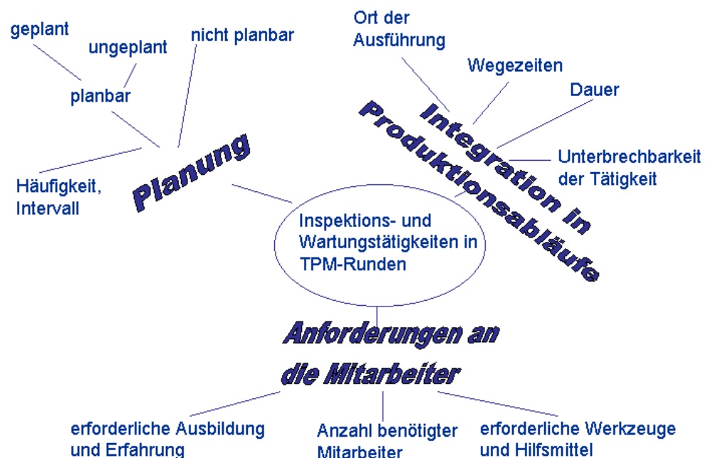
Bild 8: Strukturierung der TPM-Arbeiten
